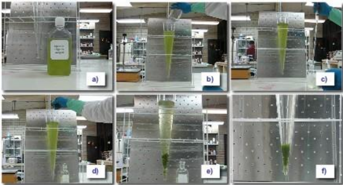
Figura 5. Proceso de Coagulación-floculación empleando quitosán. a) Muestra de agua con materiales en suspensión como algas, protozoarios, proteínas, polvo, arcilla, pigmentos, entre otros. b) El agua se vierte en un cono Hinhoff (1 L). c) Se le añade solución de floculante al 1% en una relación 1:100 floculante-agua. d) Se agita. e) Se forman flóculos y sedimentan. f) El agua queda clarificada, el material asentado se conoce comúnmente como lodo o sedimento.
